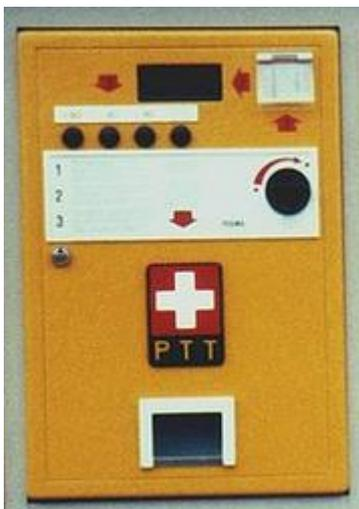
Beim einfach konzipierten Bausystem wurden einige Fehler der Versuchsmodelle behoben. Und wenn es doch zu Störungen kam, so verfügten die Geräte über eine automatische Selbstdiagnose und zeigten 23 verschiedene Störungsursachen in der Fehleranzeige.
